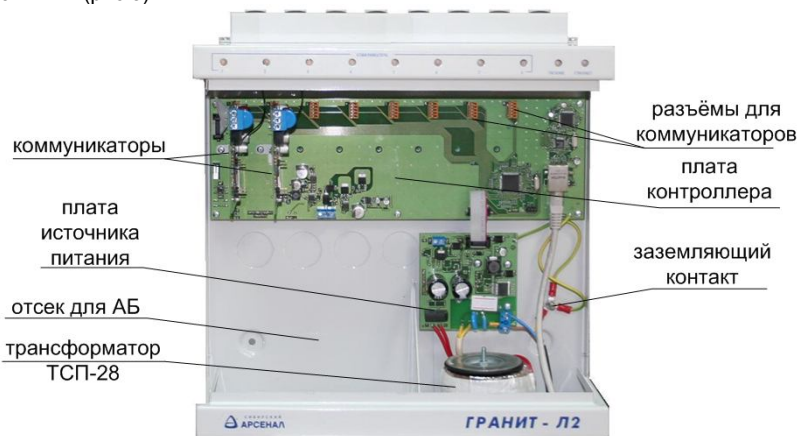
Рис.3 Внешний вид прибора с открытой крышкой
