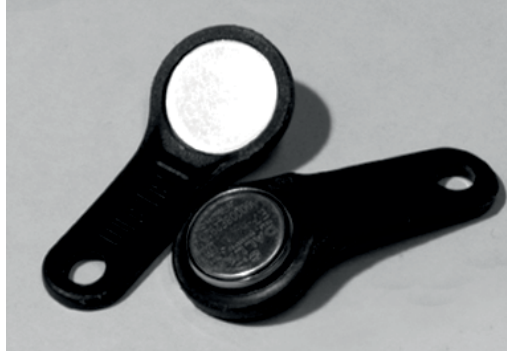
Рисунок 1 - Внешний вид ключа VIZIT-TM
