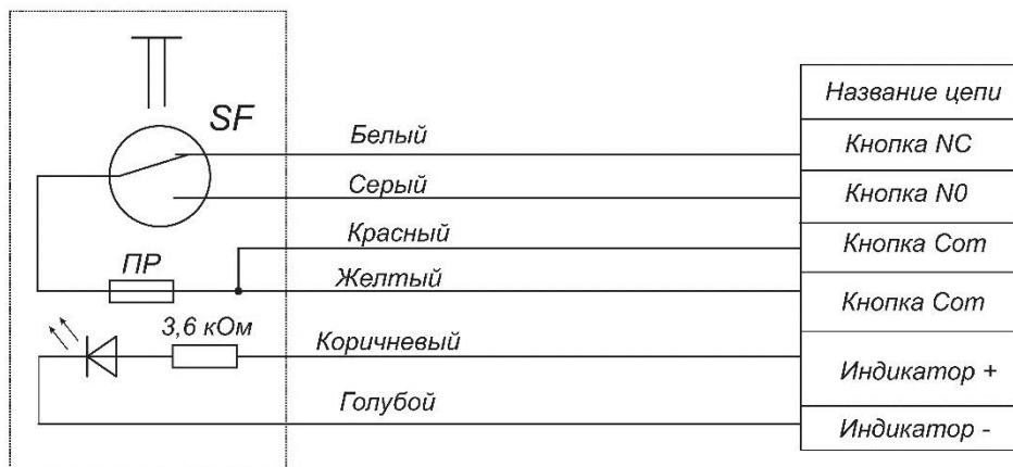
Рисунок 2 – Маркировка выводов изделия AL-BT-S03
