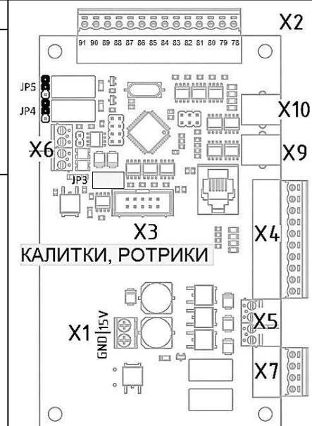
Для входных сигналов контроллер имеет 5 входов с подтягивающим резистором 2 кОм в цепи питания +15В. Управляющим элементом в системе может быть нормально разомкнутый «сухой контакт» реле или транзистор n-p-n структуры с открытым коллектором. Управляющие сигналы должны иметь длительность  $t > 0,2$  с. Транзистор или реле должны обеспечивать ток не менее 10 мА при напряжении 15 В. Управление осуществляется путем замыкания соответствующих контактов на общий провод GND контроллера (контакт 91).
