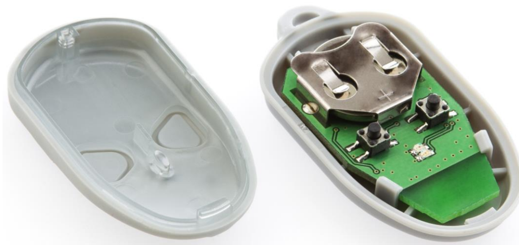
Рисунок 2. Идентификатор со снятой крышкой. Видна батарея питания
