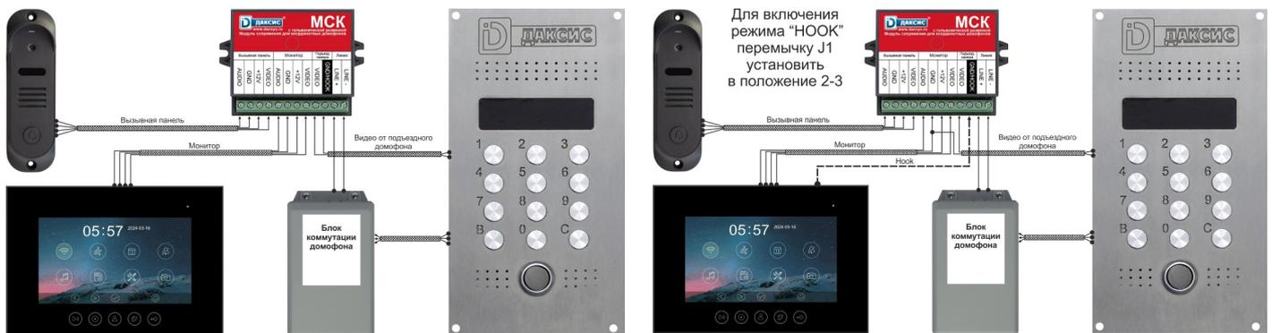
При подключении по правой схеме не забудьте перевести переключку J1 в положение 2-3, при этом назначение клеммы 10 переключится из GND во вход сигнала НООК. Общий провод сигнального кабеля подъездного видео нужно подключать к любой другой клемме GND (2 или 6) в такой конфигурации. **Если Ваш видеодомофон не оборудован выходом сигнала НООК - не переставляйте эту переключку.**
