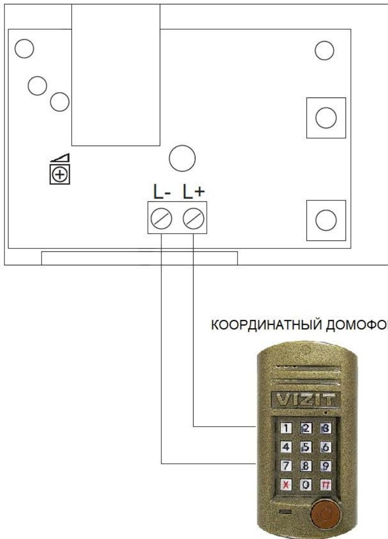
Для координатного домофона адрес устройства настраивать не нужно, так как он определяется коммутатором домофонной системы, достаточно просто подключить линию подъездного домофона на соответствующий вход трубки FE-12M.
