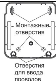
3 Через отверстие для ввода проводов подвести провода внешнего питания (при необходимости его подключения).
